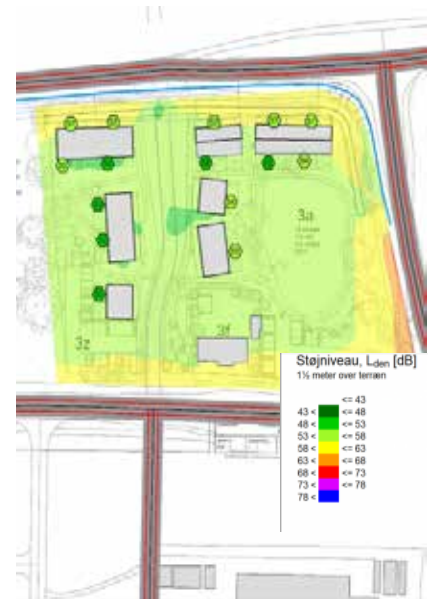
Figur 12: Konturkort over støjbelastning fra vejtrafik i 1,5 meters højde. Beregningssituation med 2,5 meter høj skærm langs med vejen 3 meter fra vejkant. Taget fra Støjrapporten fra GADE & MORTENSEN AKUSTIK A/S, hele rapporten kan ses i bilag 3
